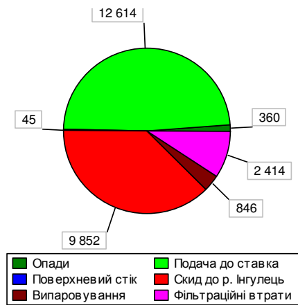
Рис. 25. Елементи водного балансу ставка-накопичувача протягом періоду «акумуляція-скид»: а,в) варіант «1», б,г) варіант «2а», д,е) варіант «2б». Надходження води – а, в, д, витрата води – б, г, е.
