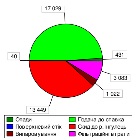
Рис. 25. Елементи водного балансу ставка-накопичувача протягом періоду «акумуляція-скид»: а,в) варіант «1», б,г) варіант «2а», д,е) варіант «2б». Надходження води – а, в, д, витрата води – б, г, е.
