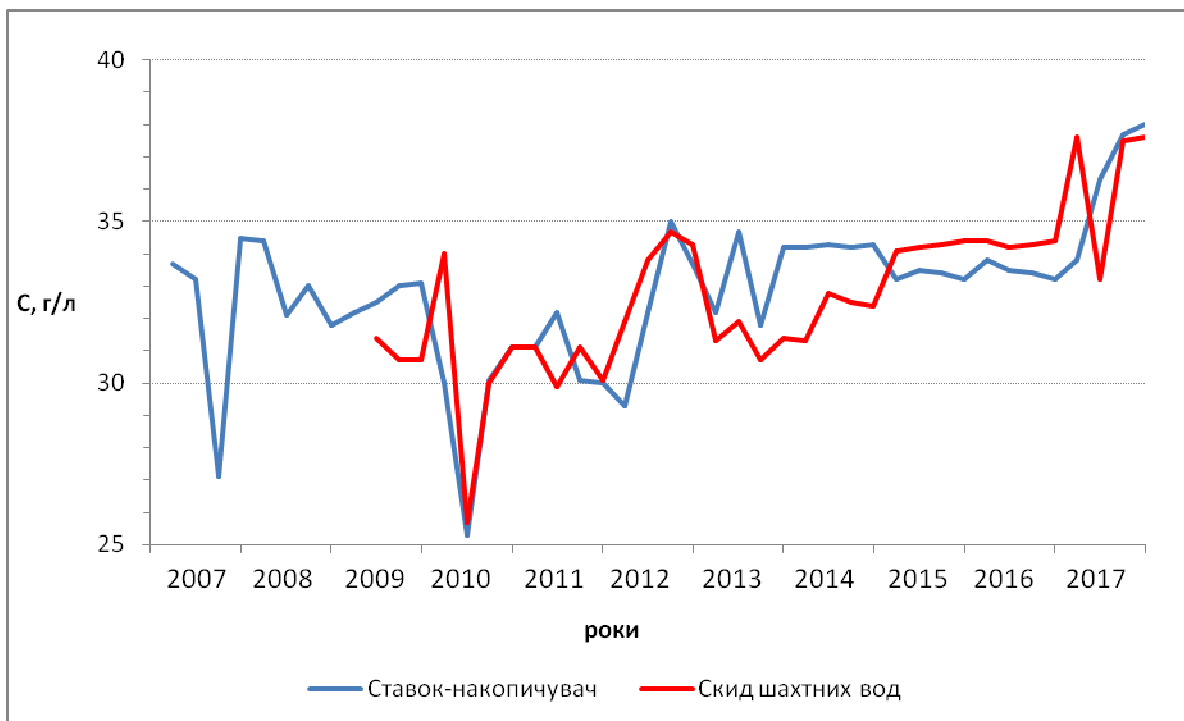
Рис.10. Зміна мінералізації вод у ставку-накопичувачу та у водах, що подаються до нього
